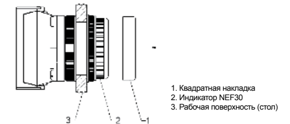
Рис. 2 Установка квадратной накладки на индикаторе NEF30
